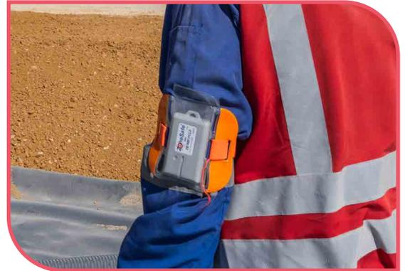
Sensores de comunicación entre camiones y excavadoras.
